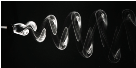
Gambar 3 Vortex Von Kármán di belakang objek silinder (hal.40)
